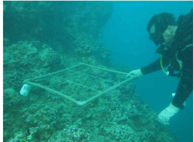
Instalação de experimento sobre balanço de carbonato em Abrolhos. Foto: Les Kaufman-CI BRASIL
